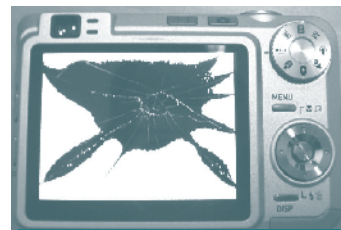
液晶が割れたデジタルカメラ
