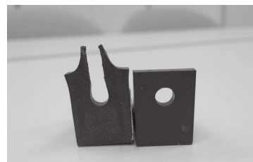
左：事故品の樹脂パーツ 右：同型新品の樹脂パーツ
